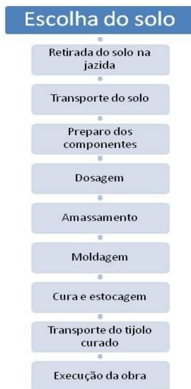
Figura 3. Etapas da produção do tijolo maciço de solo-cimento.
