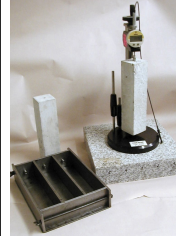
Ensaio de prisma de concreto 3/5 meses @ 60°C 12/24 meses @ 38°C
